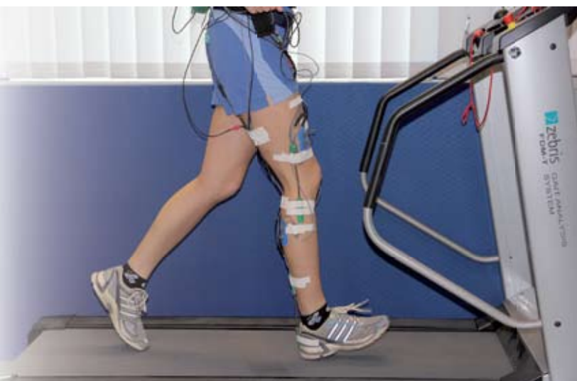
Das am Sprunggelenk angebrachte Goniometer misst den Verlauf von Pronation und Supination in Grad, während das obere Goniometer die Beugung im Kniegelenk misst
